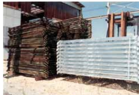
Gebrauchte Gerüstelemente vor und nach dem Feuerverzinken.
