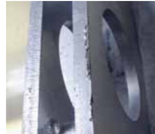
Haftprobleme auf der Laserschnittfläche und auf den scharfen Kanten.
