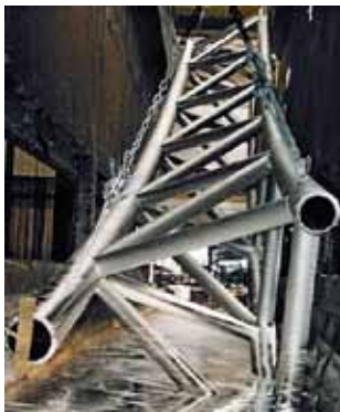
Stückverzinken: Auszug eines Mastes aus dem Zinkbad.
