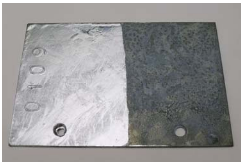
Halbseitig mit GalvaSeal eingeriebene frisch verzinkte 2mm Platte nach einigen Wochen in der freien Witterung
