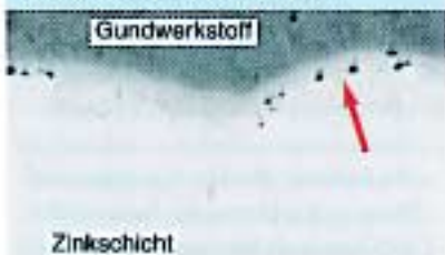
Bild 12: BSE-Aufnahme an der lasergeschnittenen Fläche der Versuchsserie E. Es sind erste Ausscheidungen einer zusätzlichen Phase erkennbar (Pfeil).
