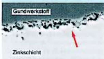
Bild 13: BSE-Aufnahme an der lasergeschnittenen Kante der Versuchsserie F. Die zusätzliche Phase am Übergang Grundwerkstoff/Zinkschicht vergrößert sich (Pfeil).
