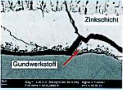
Bild 10: Geätzter Mikroschliff. BSE-Aufnahme an der lasergeschnittenen Kante im Bereich eines Schlagversuchs. Die Schichtabplatzung erfolgt am Übergang von der dunklen, eisenreichen Zone zum Grundwerkstoff (Pfeil).
